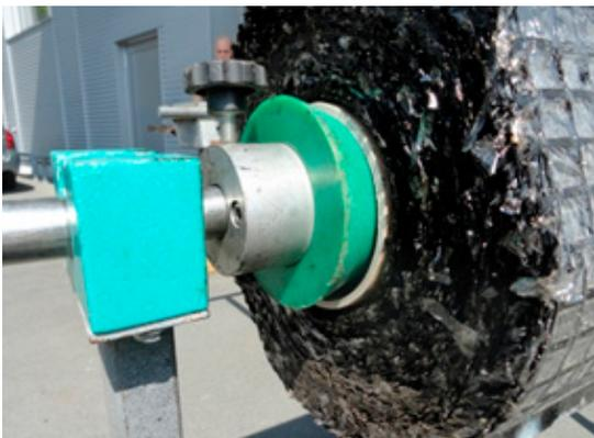
Centrer le rouleau de grille de renforcement S&P avec le cône de centrage mobile.
