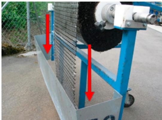
La grille de renforcement S&P doit passer à l'intérieur du cadre métallique.
