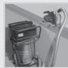
FESTO-Kreissäge mit Führungsschiene und Staubabsaugung
