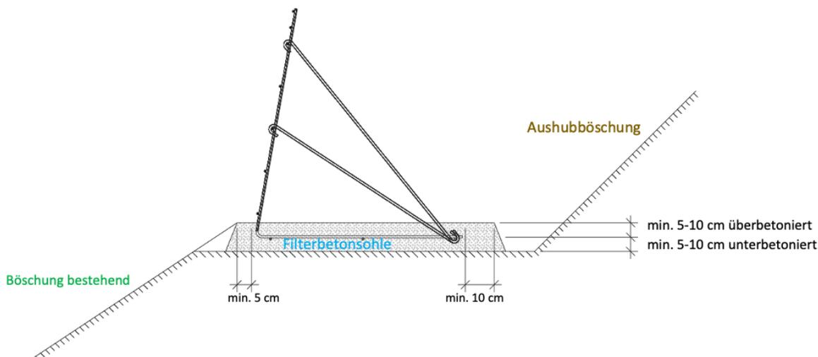
6 Die Hinterfüllung ist mit Schotter 32/50 mm an der Front der Gitter auszuführen. Bei angrenzender feinkörnigen Auffüllungen sind ca. 30 cm hinter den Gittern Trenngewebe einzulegen. Hinterfüllungen mit feinkörnigem Material  $>20$ mm sind zu vermeiden oder es muss zusätzlich eine dauerhafte, dreidimensionale Erosionsschutzmatte eingelegt werden.
