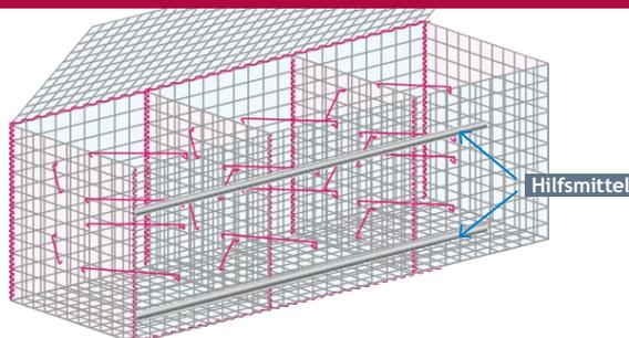
Als zusätzliches Hilfsmittel gegen das Ausbauchen, insbesondere bei Drahtstärke 3.5 mm, können Stahlrohre oder ähnliches als Hilfsmittel beim einfüllen angebunden werden.
