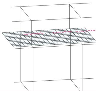
Bei der Montage mit Spiralen (mit Ringklammern nicht nötig) übereinander liegende Körbe miteinander verbinden. Den Boden des oberen Korbes mit dem Deckel des unteren Korbes im hintersten Drittel mit den 35 cm-Spiralbindern längs der Mauer mit 2 Stücke pro Laufmeter verbinden. Versetzungen sind in jeder Achse im Raster von 10 cm möglich.
