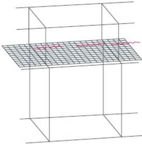
Zugdrähte über das verschweisste Kreuz an der Frontwand einhängen und mit der Rückwand verbinden, auf den Höhen 30 cm und 70 cm. Stirn- und Schlusswand mit diagonal verhängten Stäben zusätzlich sichern.
