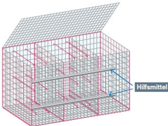
Als zusätzliches Hilfsmittel gegen das Ausbauchen, insbesondere bei Drahtstärke 3.5 mm, können Stahlrohre oder ähnliches als Hilfsmittel beim einfüllen angebunden werden.
