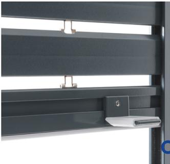
**Guide laterali** di 19 x 37 mm, in alluminio estruso anodizzato oppure termolaccato, complete di spazzole antirumore.
