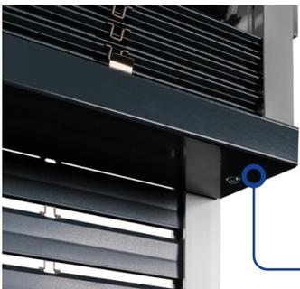
**Mantovana inferiore** di copertura del canale di raccoglimento del pacchetto in alluminio anodizzato o termolaccato. Altezza standard 40 mm. Oltre i 2'000 mm di larghezza luce, la lamiera viene fornita di 100 mm.
