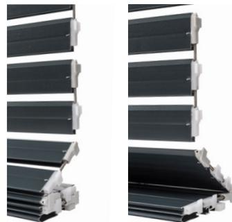
**Tappi laterali** in poliammide. Ottimo scorrimento nella guida. I tappi sono collegati tra loro per il ripiegamento forzato di due o tre stecche alla volta nella nicchia, sono fissati alla stecca tramite punzonatura (variante a 2 stecche) o con graffa antiruggine (variante a 3 stecche) e rinforzati per la migliore resistenza al vento.
