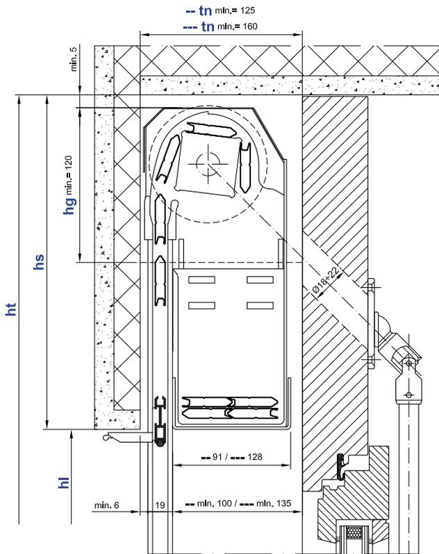
Vertikalschnitt: Behang aussen Abrollung
