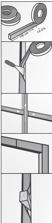
**Предварительная обработка швов и основание:** Основания/поверхности прижима должны быть максимально ровными. Удалить все загрязнения (например, остатки строительного раствора). Кромки швов должны проходить, по возможности, параллельно (при необходимости сладить шов и/или обновить профиль кромки шва (старые здания)). Соблюдать рекомендуемую ширину ленты – не допускать изменений ни в большую, ни в меньшую сторону. То же самое касается и участков с неровными поверхностями.
