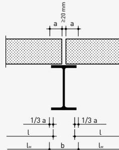
Auflagertiefe mindestens 50 mm oder 1/80 der Stützweite  $l$  der Platten; der größere Wert ist maßgebend.
