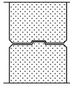
Mit Nut- und Federprofilen (vertikale und horizontale Verlegeweise)
