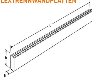
\* Die Längskanten sind standardmäßig gefast. Alle Plattenkanten sind gefast und ungestrichelt lieferbar.
