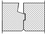
Mit Vergussquerschnitt und Nut und Feder
