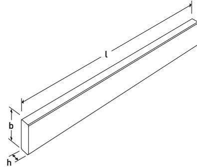
\* Standardausführung von Hebel Deckenplatten.
