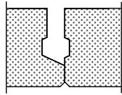
Mit formschlüssigem Vergussquerschnitt (für Dachscheibenausbildung)\*
