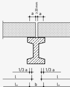
Plattenstützweite  $l < 4,00$  m:  $a > 50$  mm
