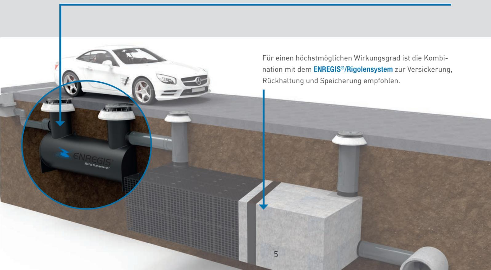
Für einen höchstmöglichen Wirkungsgrad ist die Kombination mit dem **ENREGIS®/Rigolensystem** zur Versickerung, Rückhaltung und Speicherung empfohlen.
