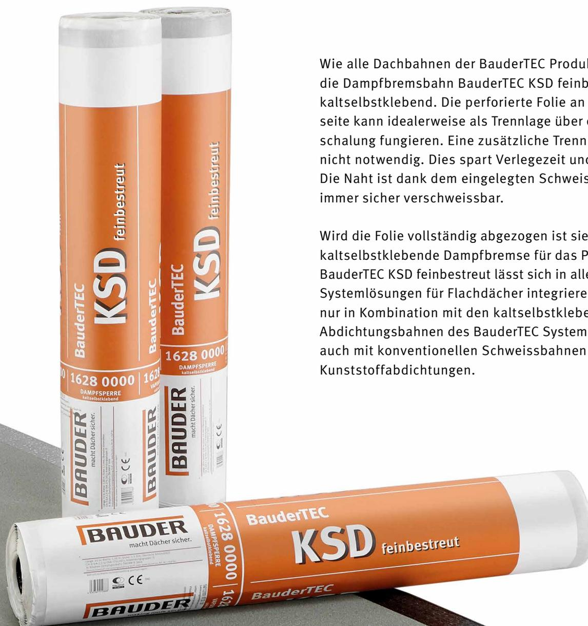
Wie alle Dachbahnen der BauderTEC Produktreihe ist die Dampfbremse BauderTEC KSD feinbestreut kaltselbstklebend. Die perforierte Folie an der Unterseite kann idealerweise als Trennlage über einer Holzschalung fungieren. Eine zusätzliche Trennlage ist nicht notwendig. Dies spart Verlegezeit und Geld. Die Naht ist dank dem eingelegten Schweissvlies immer sicher verschweisbar.
