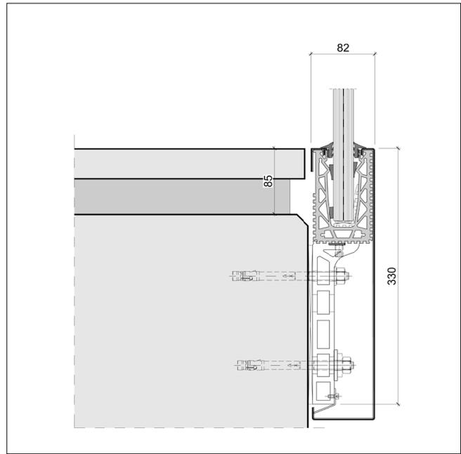
Bündig mit Betonkante (Typ D1)
