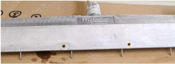
La racle à goupille doit être placée **1-2 mm plus haut** que l'épaisseur souhaitée de la couche élastique.
