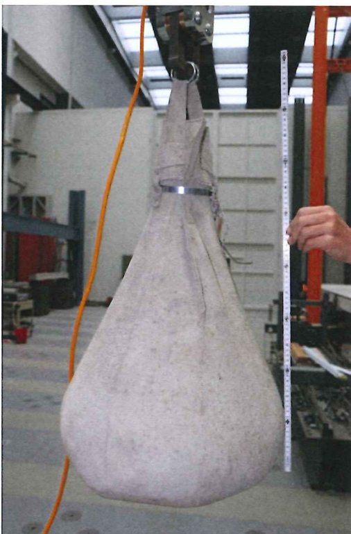
Abbildung 4: Prüfsack 50kg der Empa.
