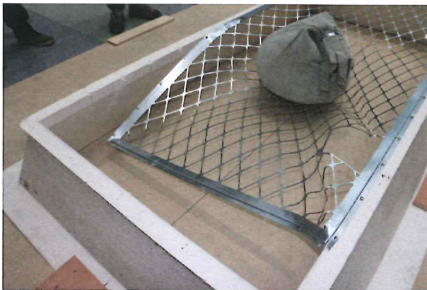
Abbildung 29: Oblicht Nr. 3 nach dem Versuch. Blick auf den freien Rand.
