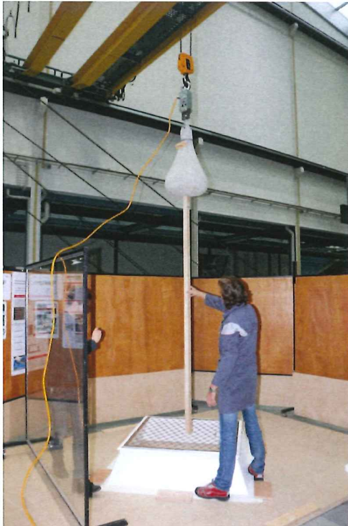
Abbildung 5: Oblicht Nr. 1 mit Gitter Nr. 1 vor dem Versuch. Abmessen der Fallhöhe. Kabel für Fernsteuerung der Ausklinkvorrichtung.
