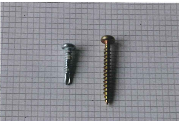
Abbildung 11: Links: verwendete Schraube für Oblicht Nr. 1 mit Gitter Nr. 1. Rechts: verwendete Schraube für alle weiteren Versuche.
