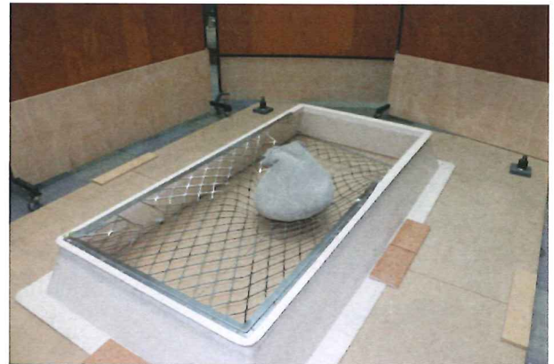
Abbildung 28: Oblicht Nr. 3 nach dem Versuch. Sichtbar ist, dass das Gitter am freien Rand abgebrochen ist. Siehe auch Abbildung 29 und Abbildung 30.
