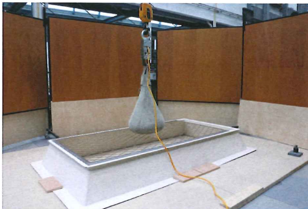
Abbildung 27: Oblicht Nr. 3 vor dem Versuch. Sichtbar ist, dass das Gitter etwas kürzer war wie der Aufsetzkranz.
