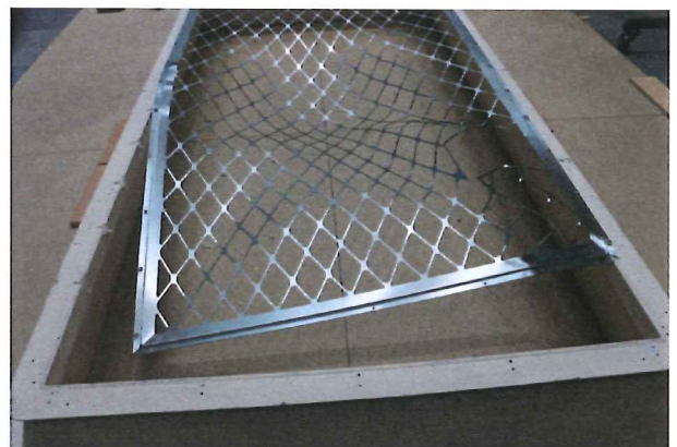
Abbildung 30: Oblicht Nr. 3 nach dem Versuch. Schrauben ausgerissen.
