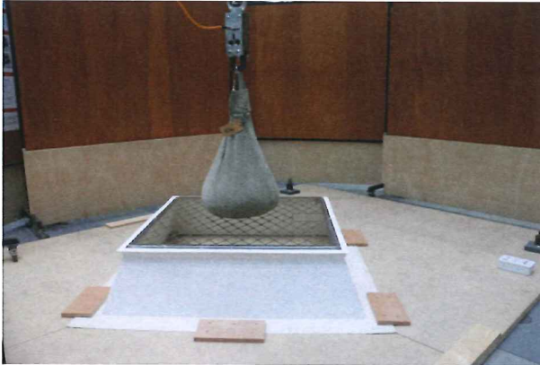
Abbildung 7: Oblicht Nr. 1 mit Gitter Nr. 1 vor dem Versuch, sichtbar ist auch die Befestigung am Boden
