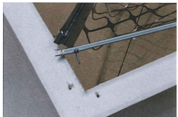
Abbildung 10: Oblicht Nr. 1 mit Gitter Nr. 1 nach dem Versuch. Schrauben im Ecke aus dem Holz ausgezogen.
