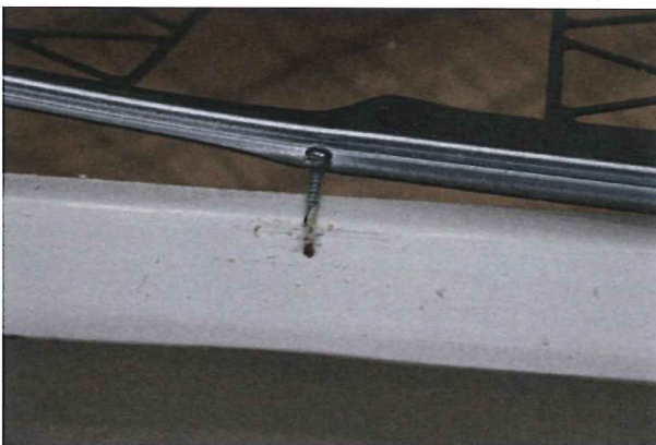
Abbildung 9: Oblicht Nr. 1 mit Gitter Nr. 1 nach dem Versuch. Schraube aus dem Holz ausgezogen.
