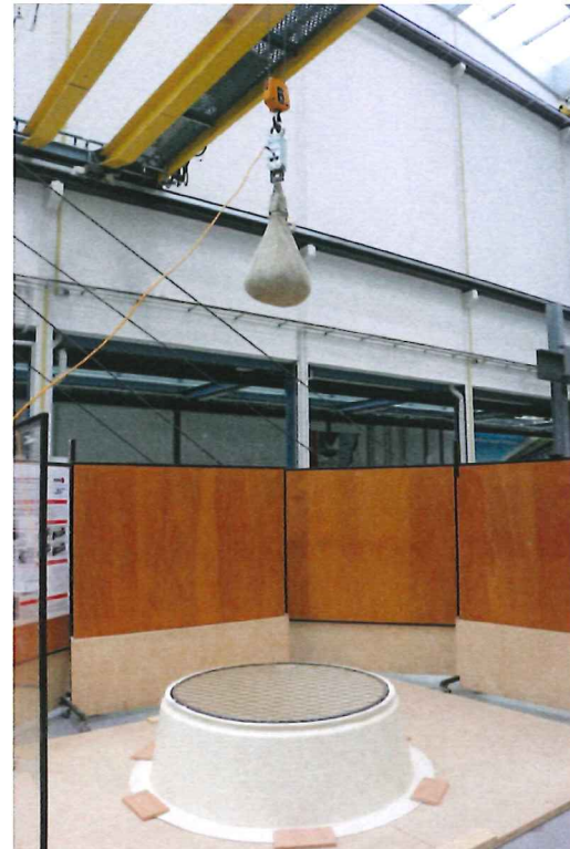
Abbildung 6: Oblicht Nr. 4 vor dem Versuch, sichtbar ist der Prüfsack und die Ausklinkvorrichtung die am Kran hängt.
