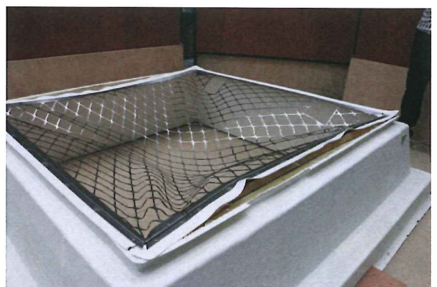
Abbildung 26: Oblicht Nr. 2 nach Versuch. Rechte Seite.
