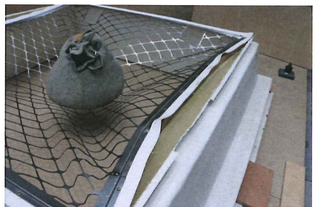
Abbildung 24: Oblicht Nr. 2 nach dem Versuch. Rechte Seite.
