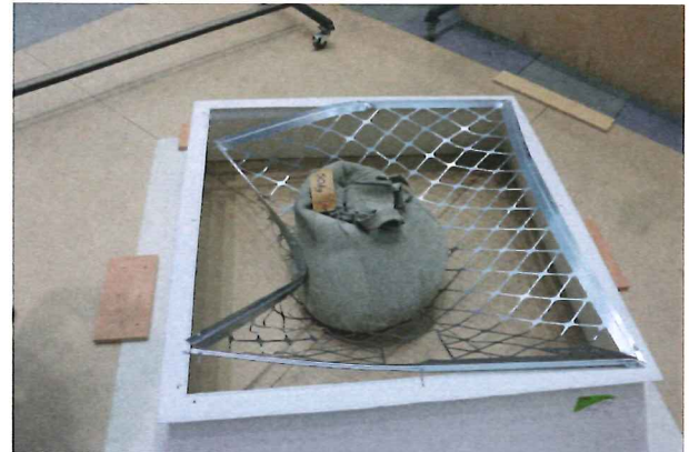
Abbildung 8: Oblicht Nr. 1 mit Gitter Nr. 1 nach dem Versuch. Prüfsack durchgebrochen.
