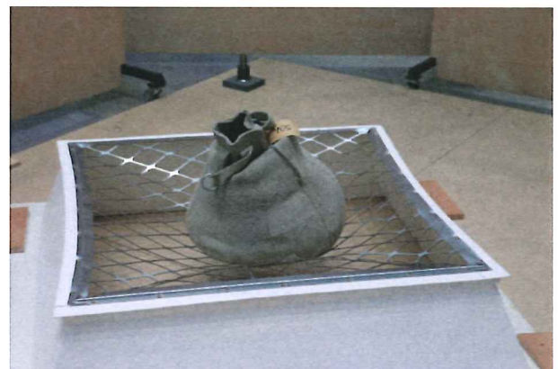
Abbildung 14: Oblicht Nr. 1 mit Gitter Nr. 2 nach dem Versuch.
