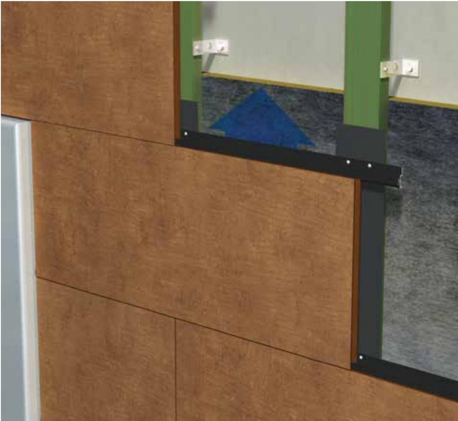
Les modules ME05 FR livrés prêt à poser sont mis en œuvre par emboîtement sur des rails en aluminium ME05 FR, fixées sur une ossature verticale en chevrons bois ou profils métalliques (uniquement ossature bois en zone sismique), solidarisés à la structure porteuse par pattes équerres réglables. Une lame d'air ventilée de 20 mm minimum est ménagée entre la face interne des éléments ME05 FR et le nu extérieur du mur porteur ou le nu de l'isolant thermique ou le nu du pare pluie éventuel.
