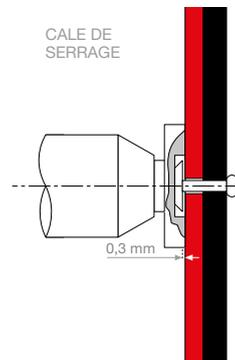
LES RIVETS DOIVENT ÊTRE POSÉS À L'AIDE D'UNE CALE DE SERRAGE, JEU 0,3 mm.
