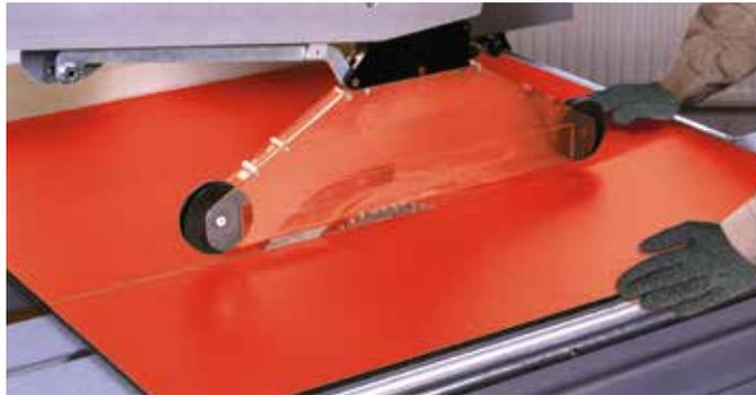
ou d'outils inadaptés. Les tables de machines doivent être lisses et si possible sans jointure afin que les copeaux ne puissent pas être retenus. Ceci est également valable pour les tables et les guides de machines portatives.
