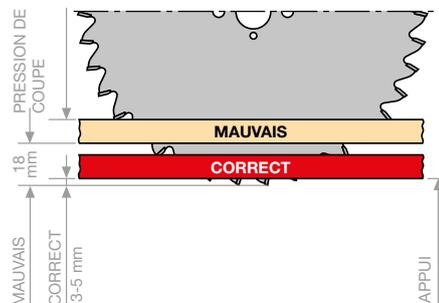
Suivant le dépassement en saillie de la lame, l'angle d'entrée et de sortie change et donc la qualité de l'arête de coupe. Si l'arête supérieure n'est pas propre, il faut remonter la lame de scie. Si c'est l'arête inférieure qui n'est pas propre, il faut redescendre la lame. C'est de cette façon que l'on détermine le réglage en hauteur optimal.
