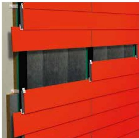
Le système ME03 FR présente l'avantage d'être simple et rapide à poser. Il est également très résistant aux chocs et au vent. Les fixations par agrafes inox procurent une haute résistance à la corrosion et les lames de clins étant découpées dans des grands panneaux bénéficient des mêmes propriétés de résistances aux UV et intempéries. Il est également possible de mixer sur une façade les clins et des grands panneaux.
