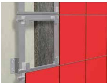
Le système ME 01 FR est spécialement étudié pour la pose en fixations invisibles des panneaux de façade Max Exterior. La procédure d'étude et de commande spécifique est disponible sur simple demande auprès de vos correspondants FunderMax. Les différents accessoires de ce système sont composés de: Panneaux Max Exterior, d'agrafes ME01 FR, d'inserts d'ancrages arrière TU SFS et de profils horizontaux en aluminium extrudés ME01 FR.
