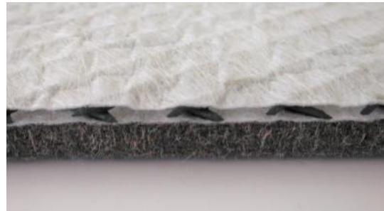
**ProtectDrain** ist ein Kombiproduct aus Polypropylen Schutzvlies und einer hochdruckfesten Drainagematte. Drainagematte und Schutzvlies sind zu einem Produkt verschweisst. **ProtectDrain** ist sehr druckfest und verfügt durch seine Masse über eine gute Schutzwirkung.
