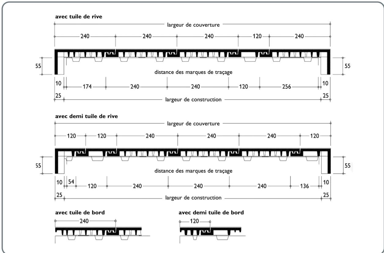
**Largeur de construction = distance des marques de traçage rive droite + tuile + rive gauche**
