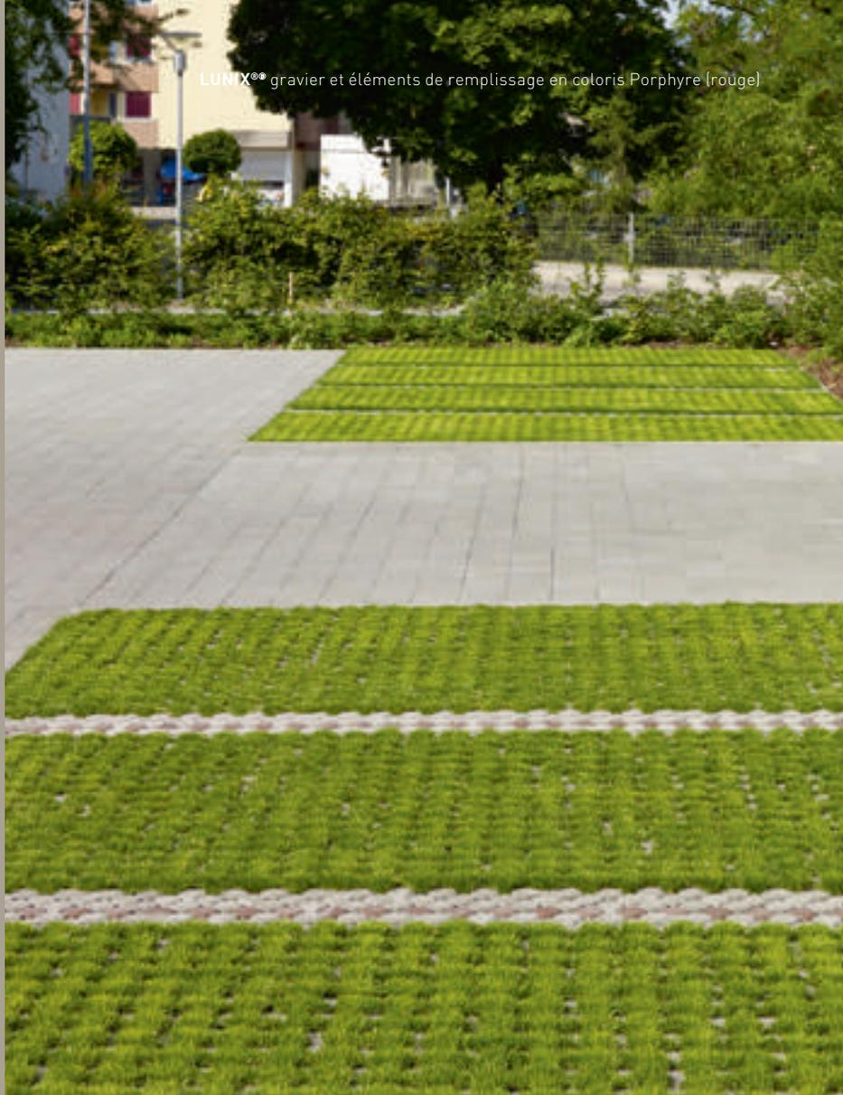
LUNIX® avec gazon et éléments de remplissage en coloris Porphyre (rouge) et gris
