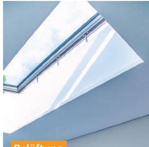
Glasoberlichter lassen sich auf ideale Weise für die Belüftung einsetzen. Weil sie in Räumen oder Treppenhäusern jeweils am höchsten Punkt eingebaut werden, kann erwärmte und verbrauchte Luft durch die natürliche Konvektion nach aussen entweichen. Die Kettenmotoren können am Aufsetzkranz oder verdeckt im Rahmen eingebaut werden.
