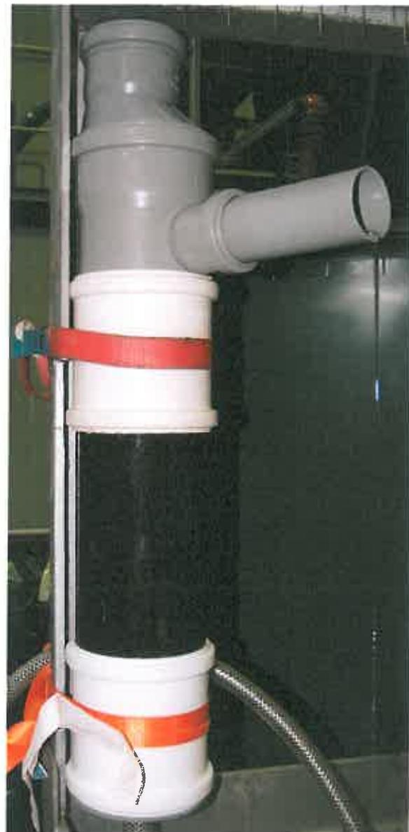
Abb. 5: Filterelement mit Zufluss am unteren und Auslauf, sowie Probenahme am oberen Ende, eingebaut in der Prüfanordnung 2
