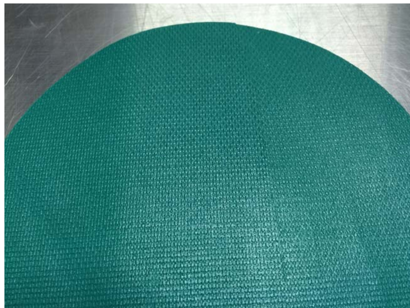
GYSO-TopWeld 520, Fügenaht Heissluft geschweisst
