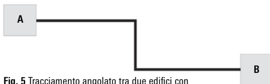
Fig. 5 Tracciamento angolato tra due edifici con assorbimento della dilatazione entro il tracciato con una curva a Z.
