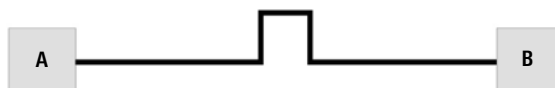
Illustration 4 Tracé droit entre deux immeubles avec absorption de la dilatation dans le cadre du tracé à l'aide d'une lyre.
