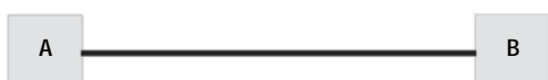
Bild 1 Gerade Trassenführung zwischen zwei Gebäuden; die Ausdehnung der Fernwärmerohre muss in Gebäude A oder B aufgenommen werden.
