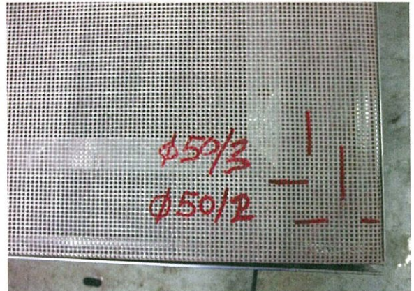
Bild 2: Ablösen des Rahmens des Alu-Rahmens nach Beschuss mit 5 cm-Eiskugel
