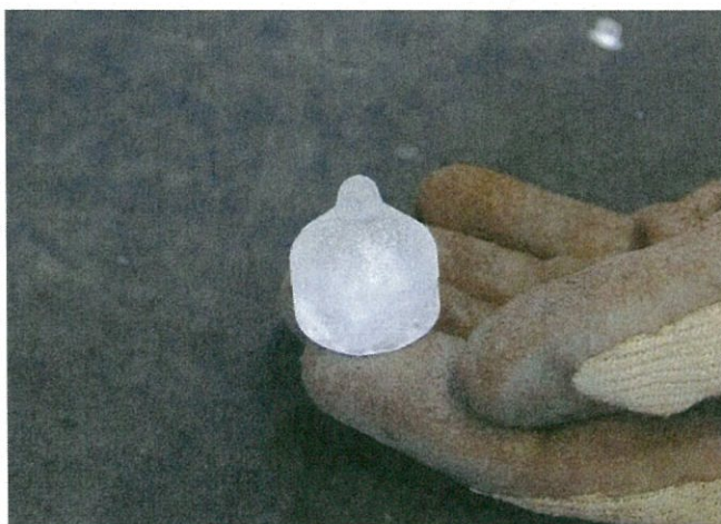
Bild 4 Tetonprojektil T40 aus Eis mit gleicher Masse wie eine Eiskugel des gleichen Durchmessers
