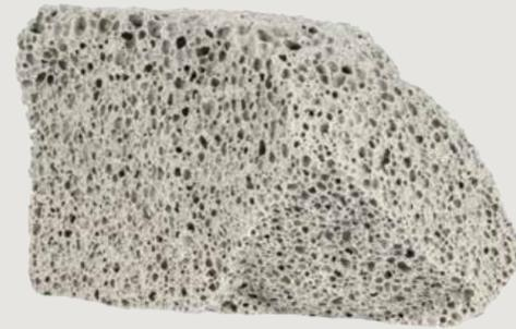
Für Perimeterdämmungen bis zur Passivhaus-Bauweise, aber auch als Leichtschüttung für befahrene Flächen mit normalen Lastanforderungen. Hervorragender Dämmwert im Neubau und für Sanierungen. Hohe Standfestigkeit, bis Nutzungsklasse N2.
