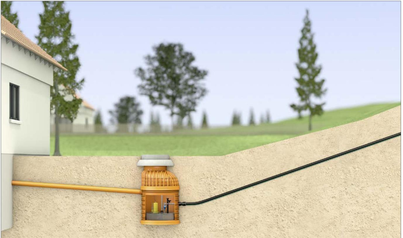
*Pumpenschacht bei Höhenunterschieden zwischen Zubringerkanal und Hauptkanal.*
