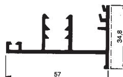
332.440 Deckleiste Kunststoff weiss mit angeschweisster Gummidichtung
