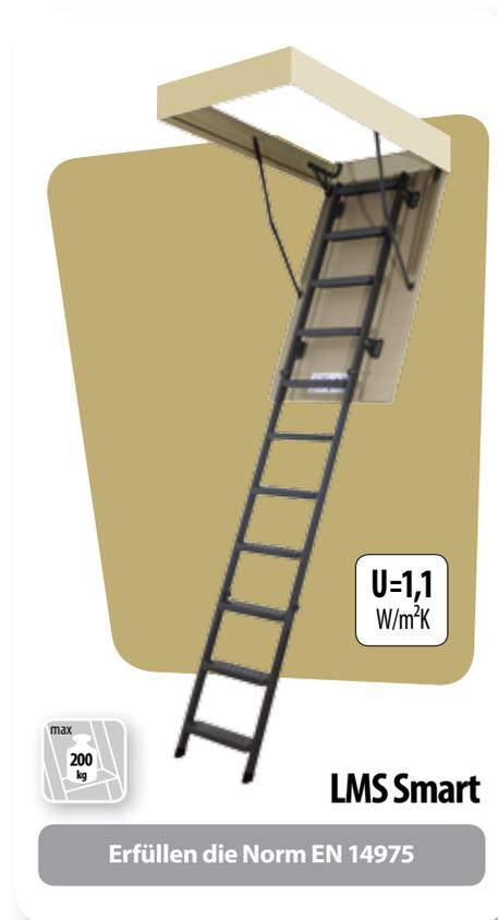
Die Estrichtreppe **LMS** ist eine dreiteilige Klapptreppe, deren Kasten und Öffnungsklappe aus Kiefernholz hergestellt ist. Die Metalleiter ist pulverbeschichtet in RAL 7022.
