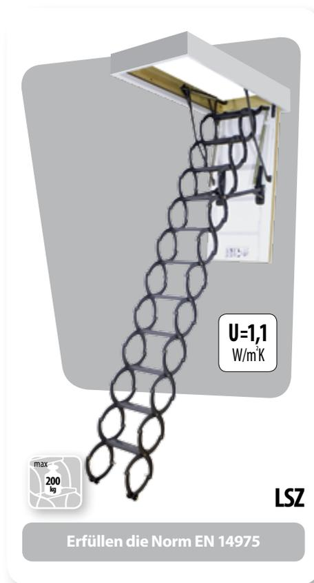
Die Estrichtreppe **LST** ist eine Scherentreppe mit weißer, gedämmter Klappe, Holzkasten, Metall-Verkleidungsleisten und Montagewinkeln für einen schnelleren Einbau. Die Scherenkonstruktion der Leiter ermöglicht platzsparendes Zusammenklappen, wodurch der Einbau bei kleinen Deckenöffnungen problemlos ist (die kleinste, lieferbare Größe ist 50x80 cm).
