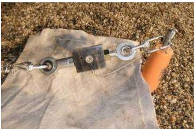
**Praktische Versuchsdurchführung mit Kraftmessgerät am Line-System: Dachaufbau Kiesschüttung**
