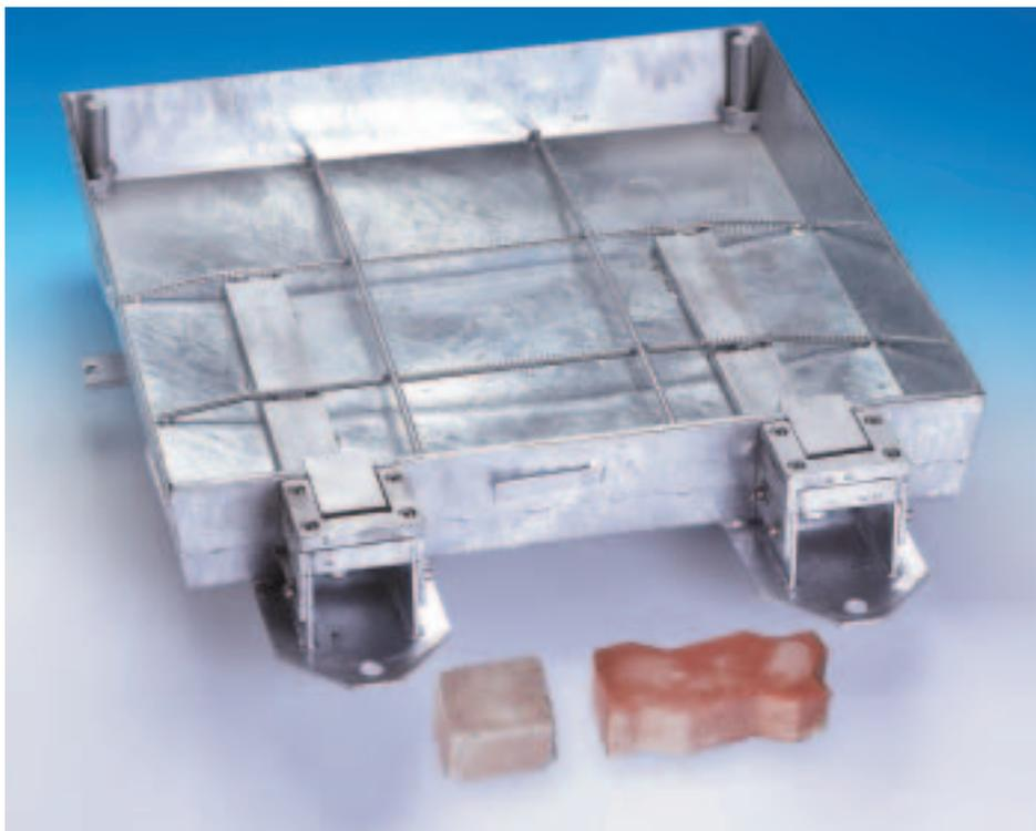
**Carico:** 125 kN forza di prova (EN 124) per riempimento con almeno 5 cm di spessore di calcestruzzo del prodotto C 35/45 (EN 206) (vedi anche pagina 3 e 29).
