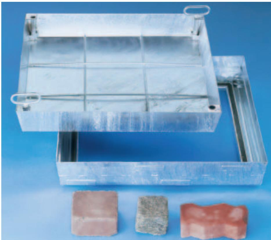
**Carico:** 125 kN forza di prova (EN 124) per riempimento con almeno 5 cm di spessore di calcestruzzo del prodotto C 35/45 (EN 206) (vedi anche pagina 3 e 29).
