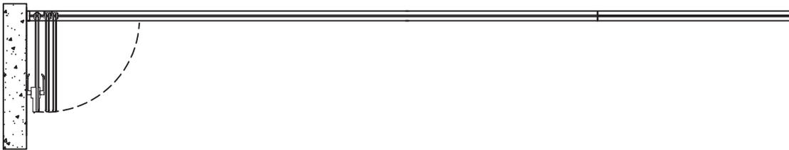
**Eckumfahrung ist nur im Fall von einem 180 Grad Systemwinkel möglich. Nach aussen zu öffnende Verglasungen müssen mit einem 2-seitigen Griff mit Klinke ausgerüstet werden. Max. 8 Scheiben an der Öffnungsseite.**
