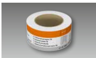
fermacell Armierungsband TB Selbstklebendes Glasgitter-Gewebe, 60 mm breit, als Fugenverstärkung für fermacell Platten mit Trockenbau-Kante.
