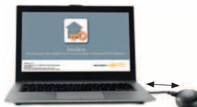
2. Anschluss der Set&Go io Hardware über USB-Kabel und Installation der Software.
