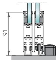
Guidage à point fixe avec profilé de plinthe
