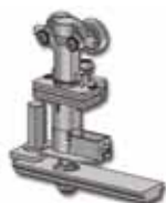
Das Fahrwerk mit Stromabnehmerteil stellt die Stromversorgung und die Datenkommunikation zur zentralen Steuerung sicher.
