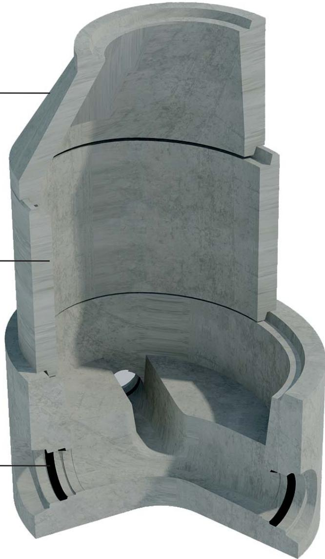
Fonds de puits FLEXOVAL® pour cheminée avec tuyaux ovoïde en béton. Le fond de puits FLEXOVAL® remplit les exigences des normes SN EN 1917/ SIA 190 et correspond à la classe de résistance pour tuyaux (CR) 60. L'étanchéité des anneaux et cônes doit être réalisée sur le chantier.
