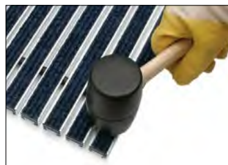
Incollare con nastro biadesivo le nuove strisce di reps nel profilo di alluminio ed eventualmente batterci sopra con un martello di gomma.
