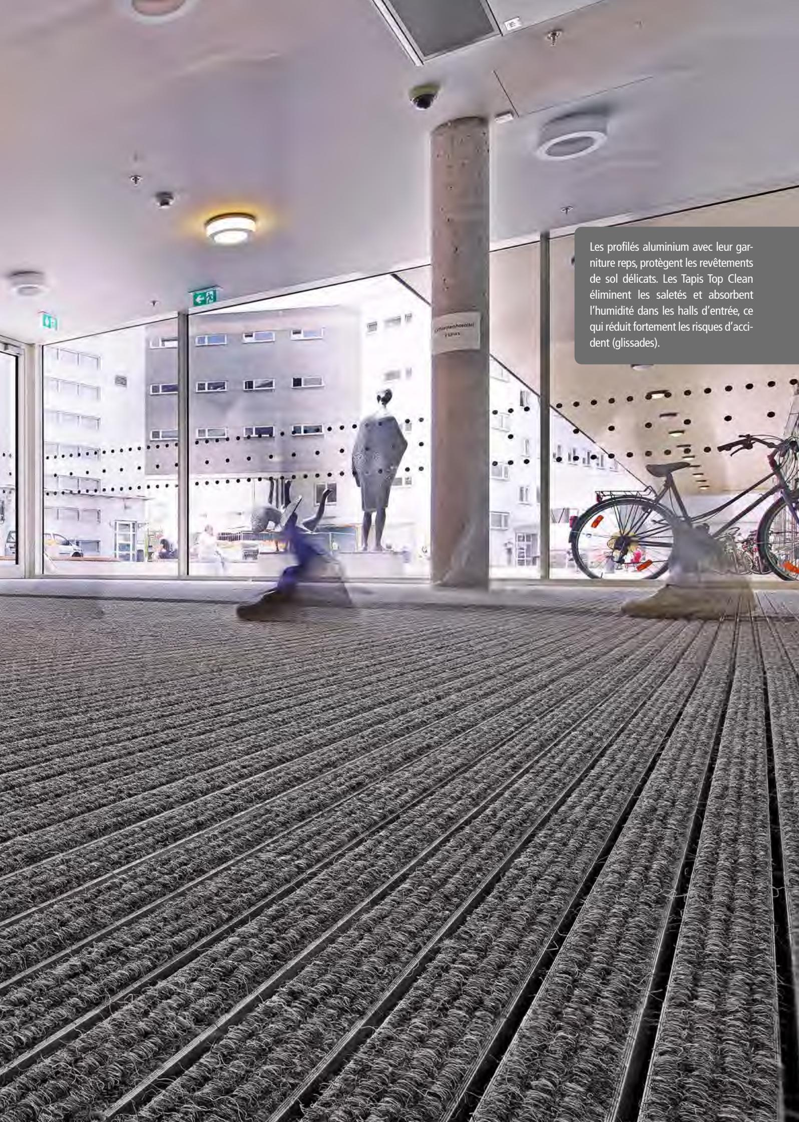
Les profilés aluminium avec leur garniture reps, protègent les revêtements de sol délicats. Les Tapis Top Clean éliminent les saletés et absorbent l'humidité dans les halls d'entrée, ce qui réduit fortement les risques d'accident (glissades).
