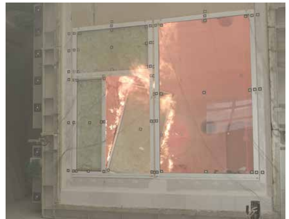
EgoKiefer Brandschutzfenster nach EI30 geprüft, garantieren eine Feuersicherheit von mind. 30 Minuten.
