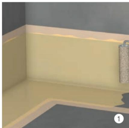
Bei Bedarf BIKUCOAT-Universalprimer 2K (gemäss UG-Tabelle S. 10–12) mittels Roller oder Pinsel auftragen.
